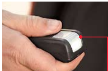
Подсветка багажника – на самом деле съемный фонарик.
