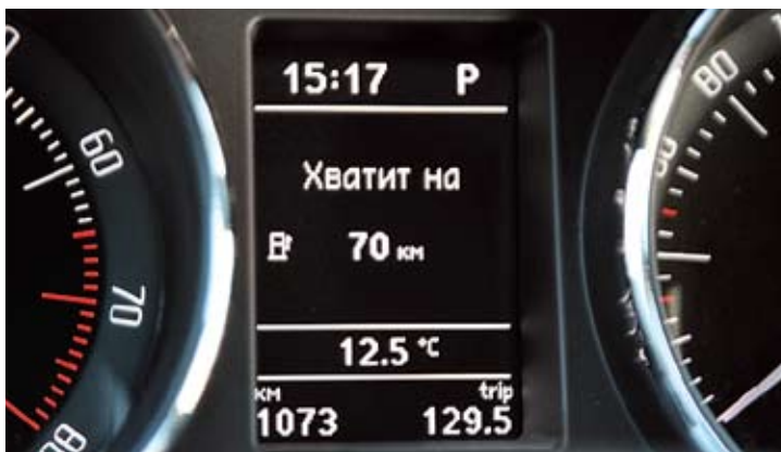
При включении зажигания стрелки спидометра и тахометра достигают своих максимальных значений, после опускаются в «0». Меню маршрутного компьютера русифицировано.
